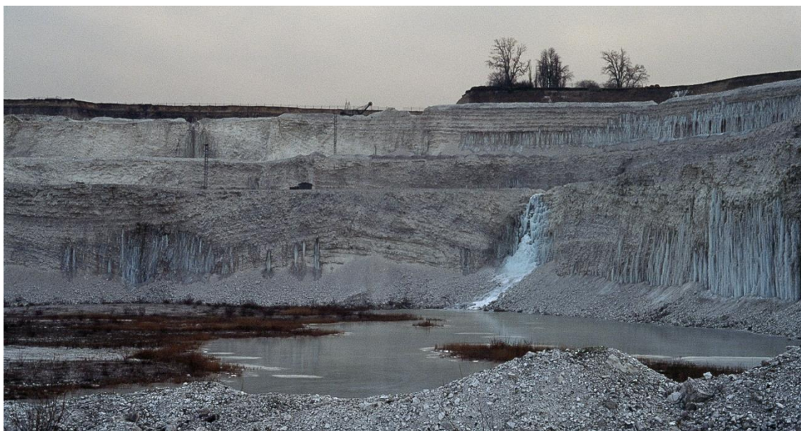
Figur 4.19. Nederst ses bryozobanker i Limhamn kalkbrud. Grundvandet der siver ud, er frosset på overfladen. Bemærk i hvor høj grad bankestrukturerne styrer grundvandsstrømningen. Øverst til højre ses den horisontale lagdeling i København Kalk Formationen. Her er udstrømningsbilledet mere jævnt, og det sker fra horisontale sprækker, der ligger mellem bænke med forskellig hårdhed (foto: Peter Roll Jakobsen).
