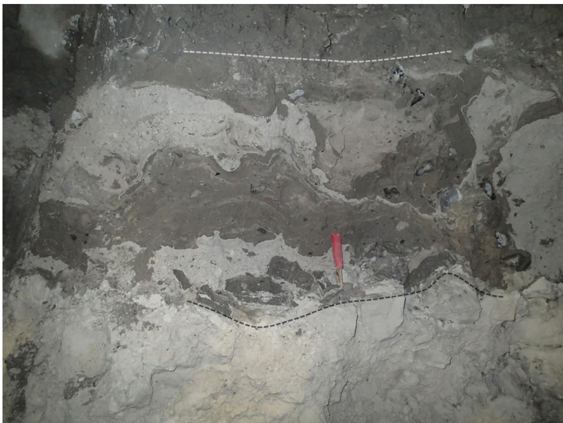
Figur 4.23. Grænsen mellem moræneler og København Kalk i Cityring-skakten for Frederiksberg station. De stiplede linjer afgrænser et stærkt deformeret grænselag mellem moræne foroven og kalk forneden, hvor partier af moræne og kalk er blandet og æltet ind i hinanden. Rødt dolkskaft er 11 cm. Foto Joakim Stiel Korshøj.
