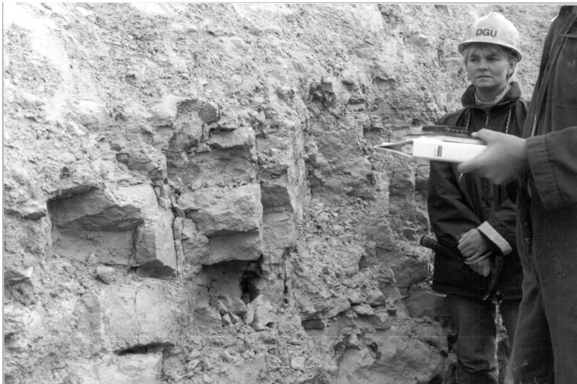
Figur 4.17. System af parallelt orienterede vertikale sprækker i København Kalk Formationen i midlertidig udgravning på Amager.
