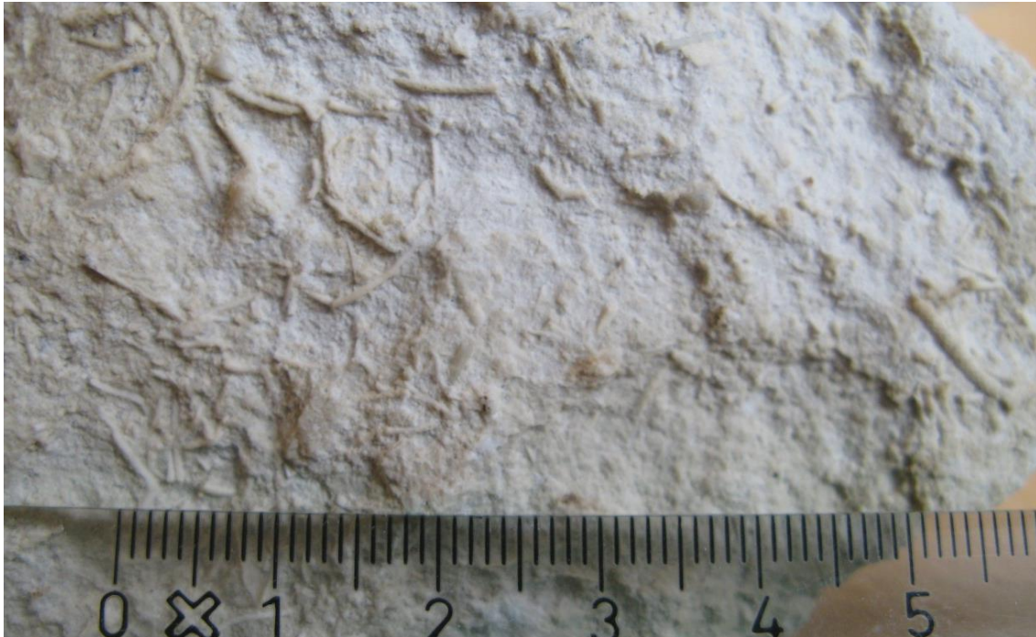
Figur 4.8 Nærbillede af bryozokalk fra Saltholm. De aflange bryozostængler ligger i en sandet (kalksand) matrix.
