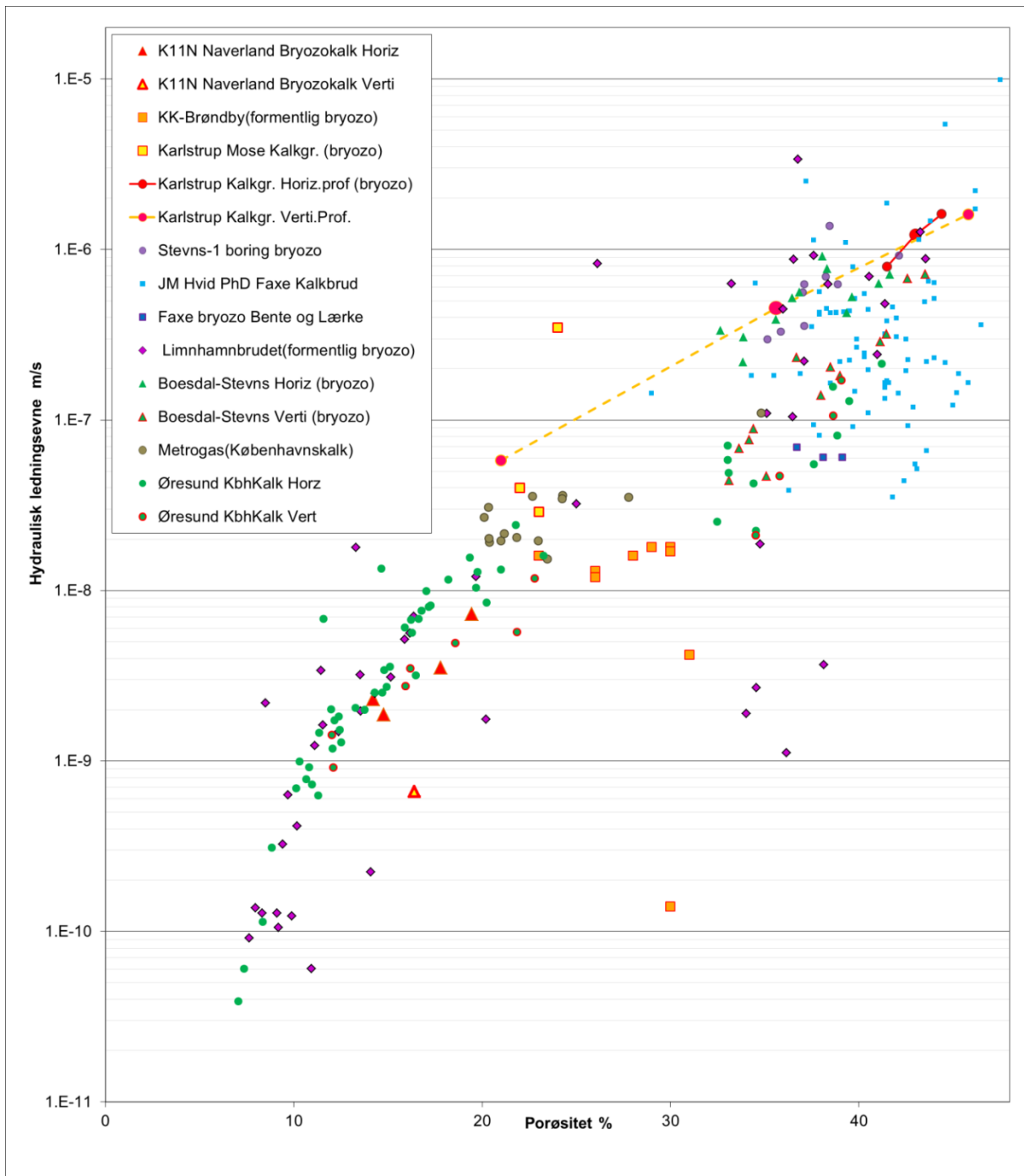
Figur 4.34: Porøsitet og permeabilitet målt på plugs fra matrix i kalksandkalken i værkstedområdet sammenholdt med andre data fra nærområdet og Stevnsområdet. Nogle af datasættene indeholder målinger af plugs taget parallelt med lagdelingen (Horiz) og vinkelret på lagdelingen (Verti.), for datasæt uden angivelse kendes orienteringen ikke, men den er sandsynligvis parallel med lagdelingen. Data forbundet med punkter er fra profiler endepunkterne dækker dataintervallet, det midterste punkt middelværdierne. Den hydrauliske ledningsevne er beregnet ud fra den målte permeabiliteten i mDarcy som er divideret med 9.1 \times 10^7 . Det vertikale profil fra Karlstrup Kalkgrav er gengivet i figur 4.21B
