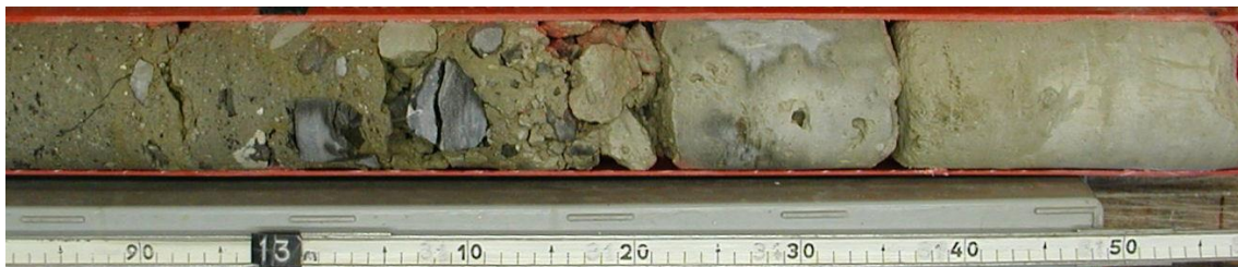
Figur 4.28. Kerneprøve fra Cityringsboring på Edisonsvej på Frederiksberg (nedad er mod højre). Ved 13.22 m overlejres hærdnede kalklag af uhærdnet men fast moræneler. I intervallet 13.16-13.22 m er morænenens finkornede dele skyllet bort under borearbejdet, så kun grus og sten ligger tilbage.
