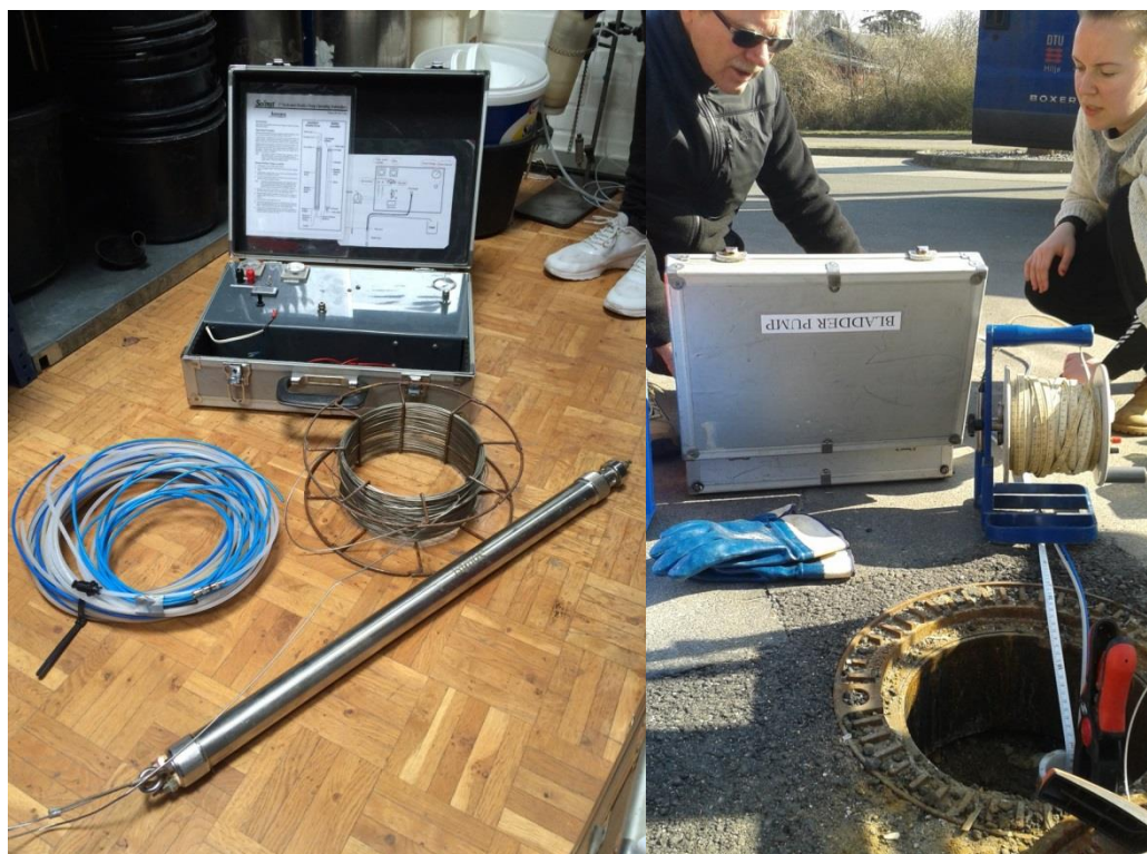
Figur 3: Niveauspecifik prøvetagning vha. lavt flow bladder pumpe. Venstre: bladder pumpe og kontrolenhed; højre: under anvendelse i felten.
