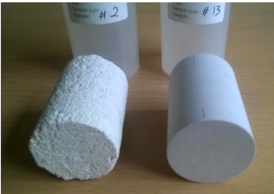
Figur 3: Billeder af en kornet kerne fra GEO4 (kote 10,47 m til 10,35 m) med hårdhed H2 (venstre) og en hård kerne fra GEO9 (kote 0,60 m til 0,39 m) med hårdhed H4 (højre) til illustration af struktur vurderingen.
