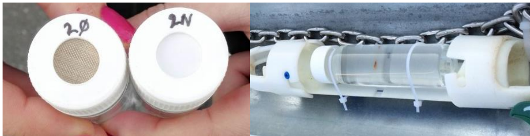
Figur 3.7. Diffusionsceller til niveauspecifik prøvetagning. Venstre: membran låg med hhv. teflon belagt glasvæv og LDPE membran; og højre: diffusionsceller monteret på snapsamplere parat til installation i felten.
