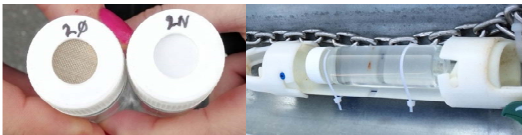
Figur 9. Diffusionsceller til niveauspecifik prøvetagning. Venstre: membran låg med hhv. teflon belagt glasvæv og LDPE membran; og højre: diffusionsceller parat til installation i felten.
